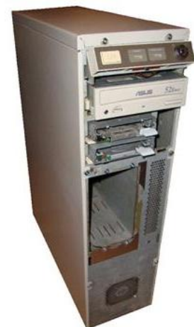
A3000T: Die zwei Diskettenlaufwerke mit 1" Höhe brauchten spezielle Schienen und der Auswurfkнопf mussten angepasst werden.
